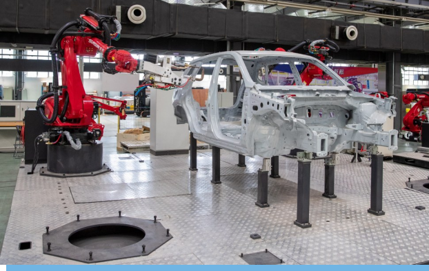
这是2024年6月12日在辽宁省沈阳新松机器人自动化股份有限公司拍摄的白车身点焊机器人。（新华社记者 李旭伦 摄）
