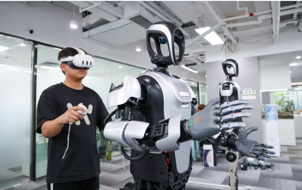
2025年3月27日，在乐聚（深圳）机器人技术有限公司，技术人员在调试人形机器人“夸父”。（新华社记者 梁旭 摄）
