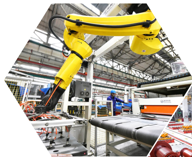
▲2024年2月22日，在哈电集团哈尔滨电机厂有限责任公司生产车间，工作人员在操控自动涂漆机械手智能化改造项目的智能设备。（新华社记者 王建威 摄）
